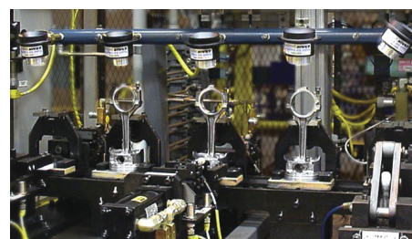
Fünf Modelle 120022 2" (51 mm) Super Air Amplifier kühlen LKW-Kolben vor der Messung.
