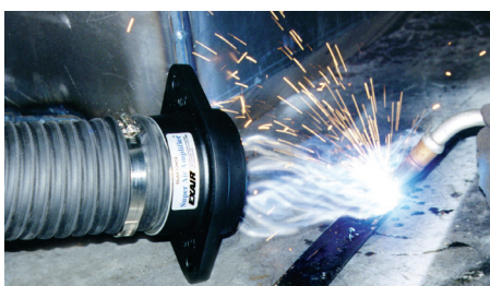
Der Super Air Amplifier, Modell 120024 (4") saugt entstehenden Rauch bei Schweißarbeiten ab.
